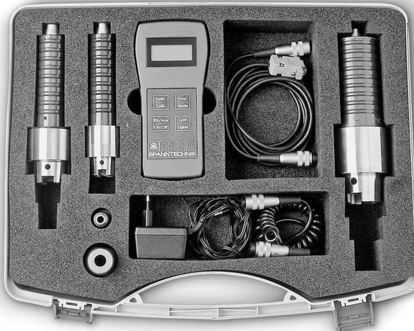
Exemple : Système de mesure de la force de serrage Berg
