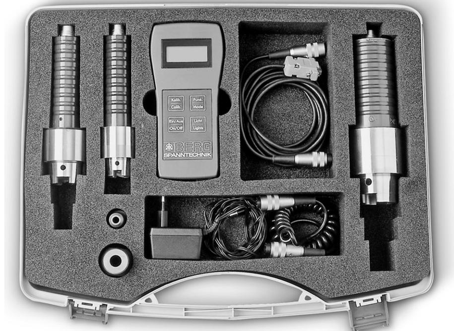
Exemple : Système de mesure de la force de serrage Berg
