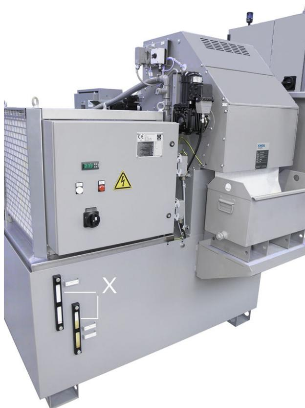
**Affichage du niveau de remplissage sur une installation de préparation de lubrifiant-réfrigérant (sté. Knoll)**
