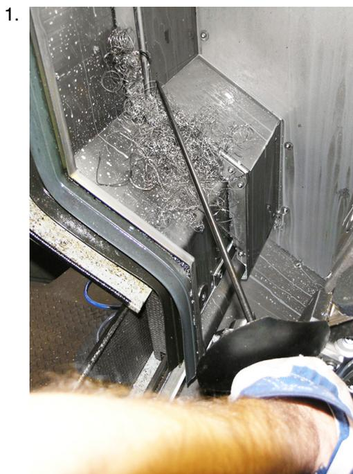
Exemple : Éliminer les amas de copeaux à l'aide d'un outil approprié (par ex. crochet à copeaux)
